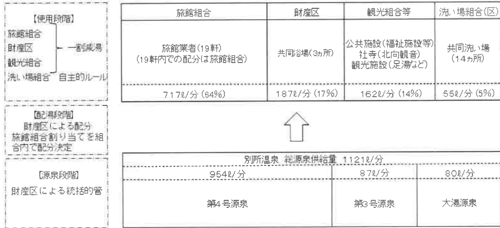
図3 源泉・配湯・使用それぞれの段階の管理 (注) 財産区資料および聞き取りにより作成。
